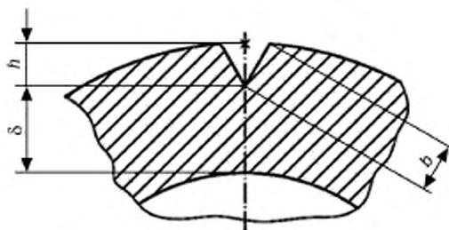
$b$  — ширина обработанной фрезерованием поверхности надреза;  $h$  — глубина надреза;
