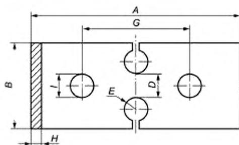
Рисунок ДД.1 — Испытуемый образец типа В
