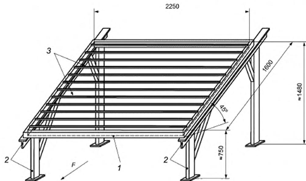
1 — съемная рама; 2 — опоры; 3 — съемные стержни для крепления образцов;
