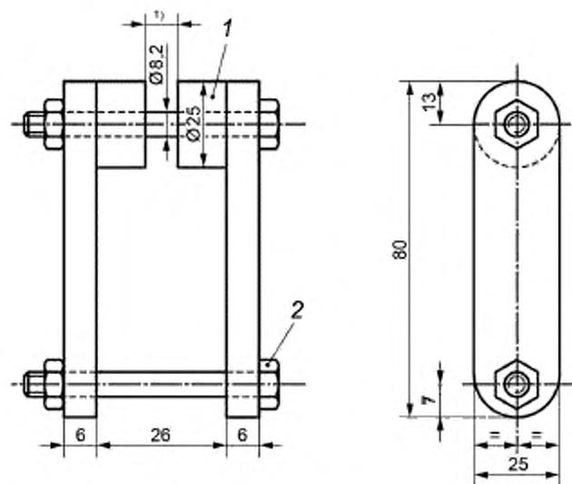
1) Размер зазора для крепления натяжной цепи или веревки.
