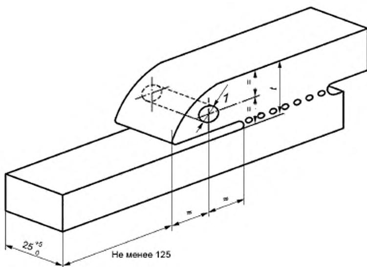
1 — отверстие для болта рычага, диаметром  $\#5$ , но не менее 3 мм
