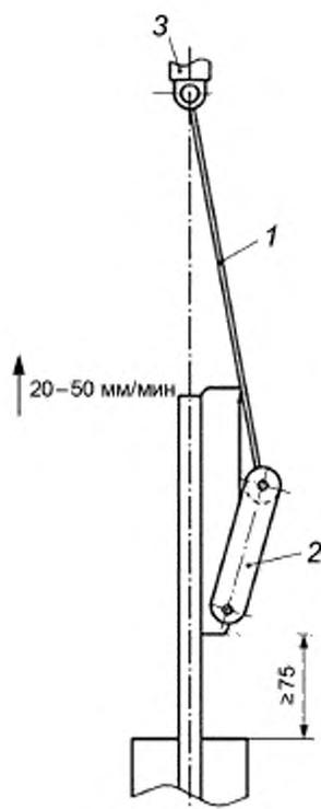
1 — передаточная цепь или трос (минимальная длина 300 мм); 2 — рычаг, преобразующий усилие растяжения в усилие отрыва;
