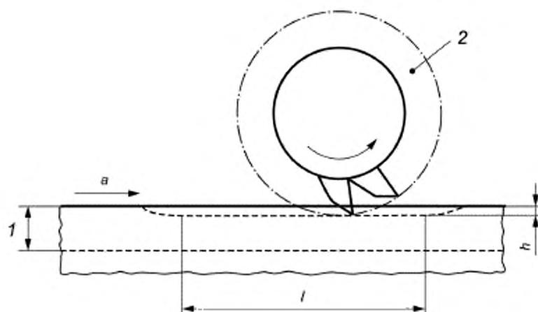
1 — стенка трубы; 2 — двусторонняя фреза с зубьями под углом 60°; а — подача;
