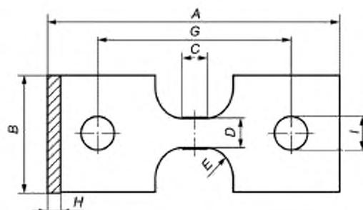
Рисунок ДД.2 — Испытуемый образец типа С
