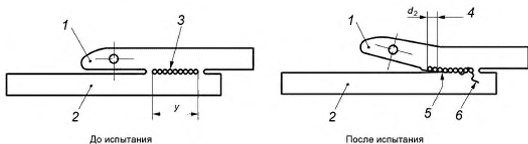
1 — муфта; 2 — труба; 3 — витки электронагревательной спирали; 4 — хрупкое разрушение в зоне сварки, 5 — разрушение в зоне спирали с пластической деформацией материала; 6 — пластическое разрушение трубы
